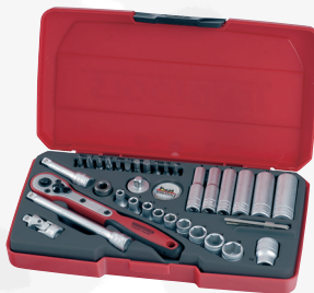
PIPENØKKELSETT T1436 MED 1/4" FIRKANTFESTE
